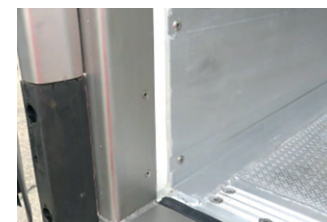
Izolacja termiczna, profile aluminiowe na podłodze
